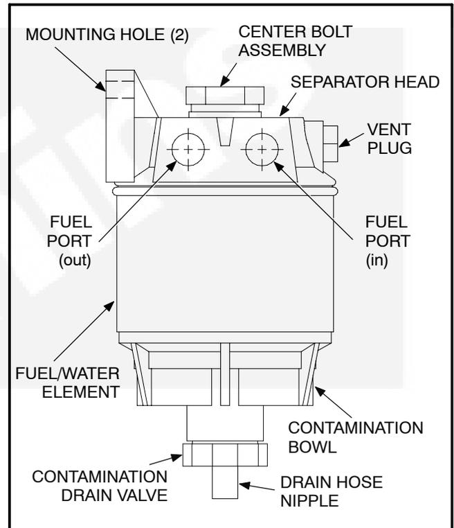
**FIGURE 8. FUEL/WATER SEPARATOR**
